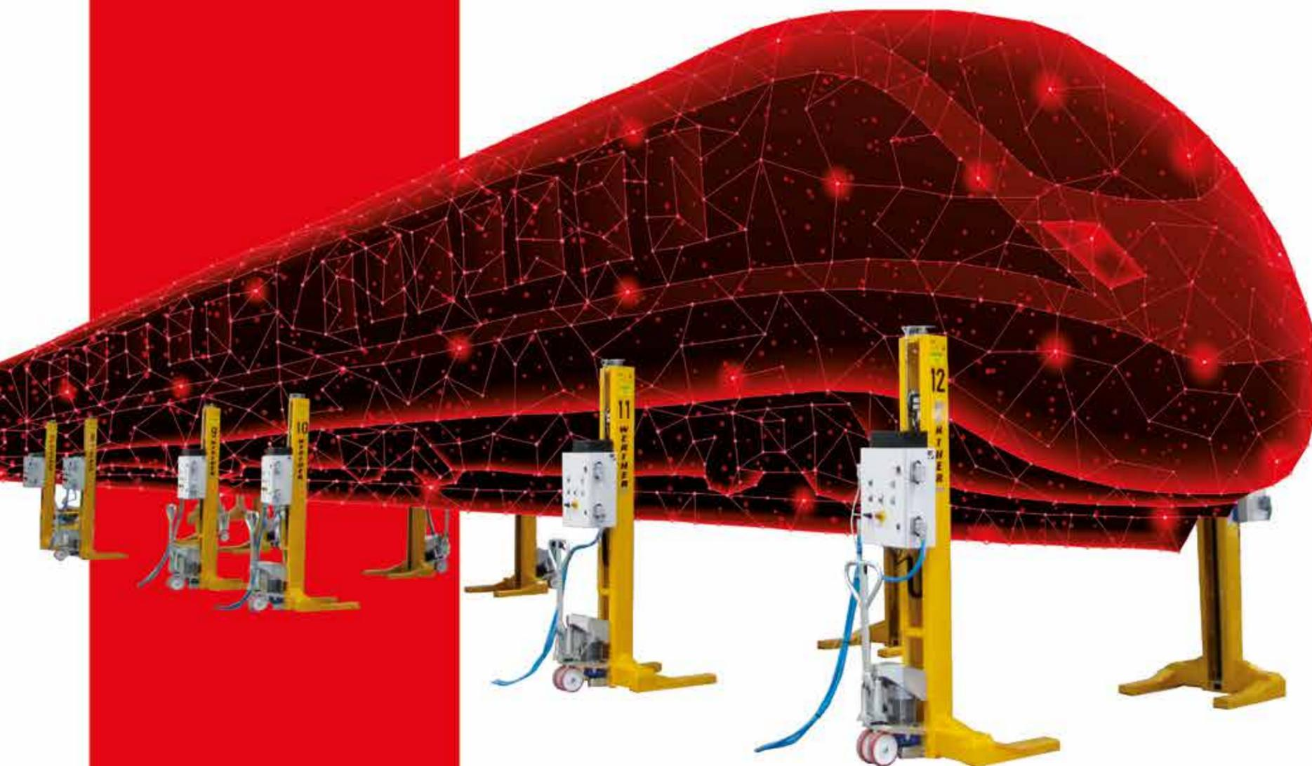
La modularità del sistema permette soluzioni molto flessibili. Un sistema di sollevamento composto, ad esempio, da 16 colonne mobili può essere usato come impianto unico, oppure come due impianti da 8 colonne, fino a un massimo di 4 gruppi separati da 4 colonne ciascuno. I gruppi possono anche essere utilizzati separatamente collegando, in questo caso, più centraline di comando POLAR.
